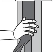
6. Izolaci TUBEX Sonik lze aplikovat na potrubí i dodatečně. Je vhodné použít izolaci s větším vnitřním průměrem než deklarovaný průměr izolovaného potrubí. Izolace se rozdílné a spoj se přelepí vhodnou páskou.
